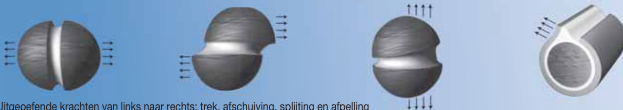
Uitgeoefende krachten van links naar rechts: trek, afschuiving, splijting en afpelling
